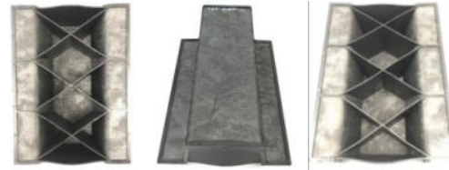
Abb. 4: Hutprofil mit vollständig gefüllten Schmelze-Kavitäten
