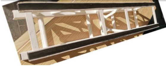
Abb. 19: Gerader Träger mit automatisiert eingebrachten endlosfaserverstärktem CFK (schwarz) in 3D-gedruckte Struktur (weiss)
