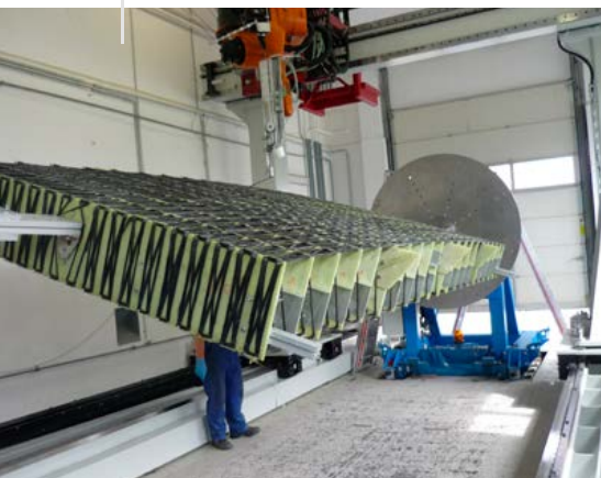
Fertigung eines CFK-Brückenmoduls © Baltico
