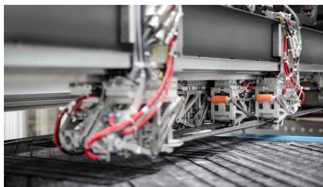
digitale Fertigungsstraße für CFK-Rückwand © Voith
