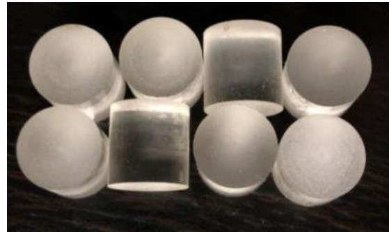
Abbildung 1-3: Teilweise ausgehärtete (a) Zug- und (b) Druckprüfkörper
