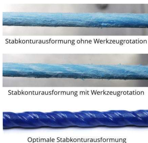
Abbildung 5-2: Ergebnisse der Stabkonturausformung
