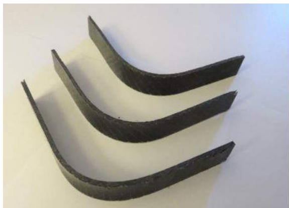
Abbildung 1-6: Beispielhafte Ergebnisse der Biegeversuche an CFK-Verbundproben mit (a) ±45° und (b) 0° Faserausrichtung
