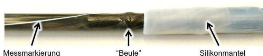
Abbildung 6-4: Detail eines verdrehten Probekörpers
