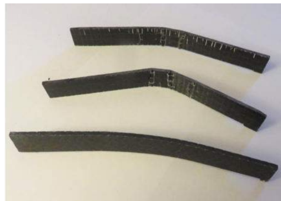
Abbildung 1-6: Beispielhafte Ergebnisse der Biegeversuche an CFK-Verbundproben mit (a) ±45° und (b) 0° Faserausrichtung
