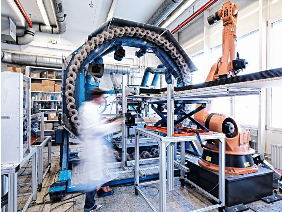
Abbildung 2: Automatisierte Herstellung eines CMC Bauteils mittels Flechten. Quelle: Ariane Group
