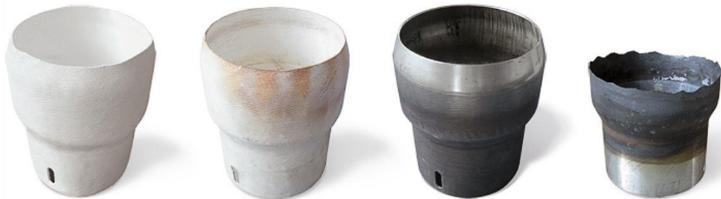
Abbildung 1: Brennerdüse aus einer oxidischen Faserverbundkeramik (CMC) und aus Stahl; von links nach rechts: CMC neu und nach 10.000 h bei > 1.000 °C; Stahl neu und nach 10.000 h bei > 1.000 °C; Quelle: Pritzkow Spezialkeramik
