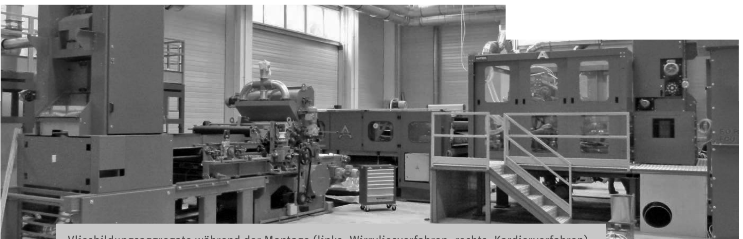
Vliesbildungsaggregate während der Montage (links: Wirtvliesverfahren; rechts: Kardierverfahren)
