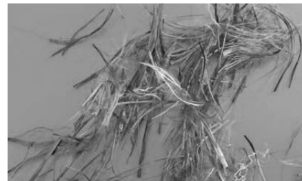
Abb. 1: Carbonfaserrezyklat nach einstufigem Reißprozess
