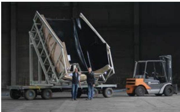
Präzises Formwerkzeug zur Herstellung von Faserverbund-Großbauteilen bei der LS KORROPOL GmbH
