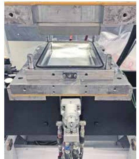
RTM-Werkzeug zur Herstellung der monolithischen Coupon-Probekörper
