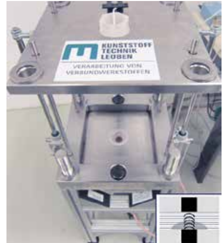
Prüfstand zur Charakterisierung der transversalen Permeabilität textiler Verstärkungsstrukturen.
