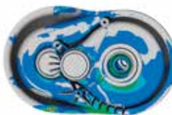
FE-Berechnung zur Prüfung der Gehäusesteifigkeit und -festigkeit
