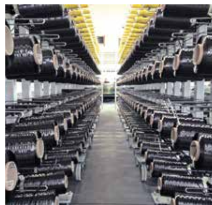
Abb. 2: Abzugsgatter für Carbonfaserrovings
