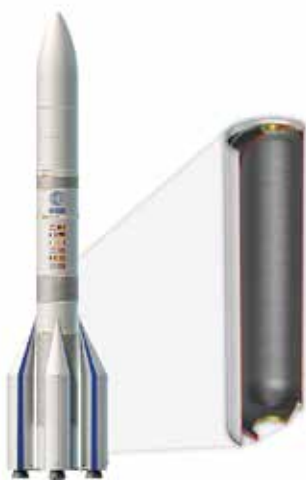
Abb. 1 a: Geplantes Raketengehäuse der Ariane 6 (A64 vier Booster Konfiguration) aus kohlenstofffaserverstärktem Kunststoff.
