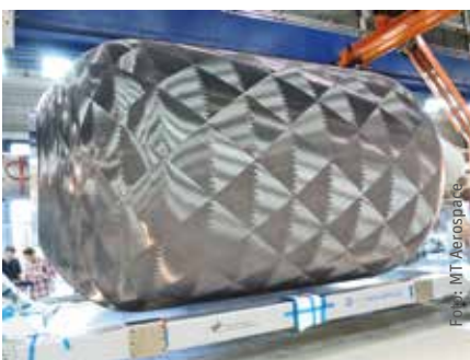
Abb. 1 b: Fertiggestellter trocken gewickelter Kohlenstofffaser Demonstrator, bereit zur Infusion
