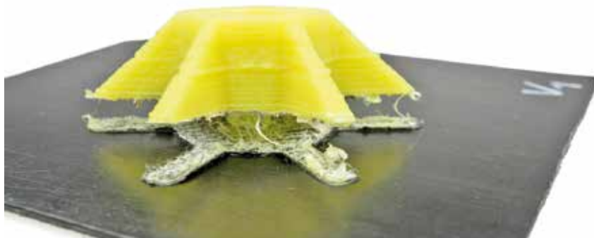
Abb. 2: Versagen Schraubdom im Test
