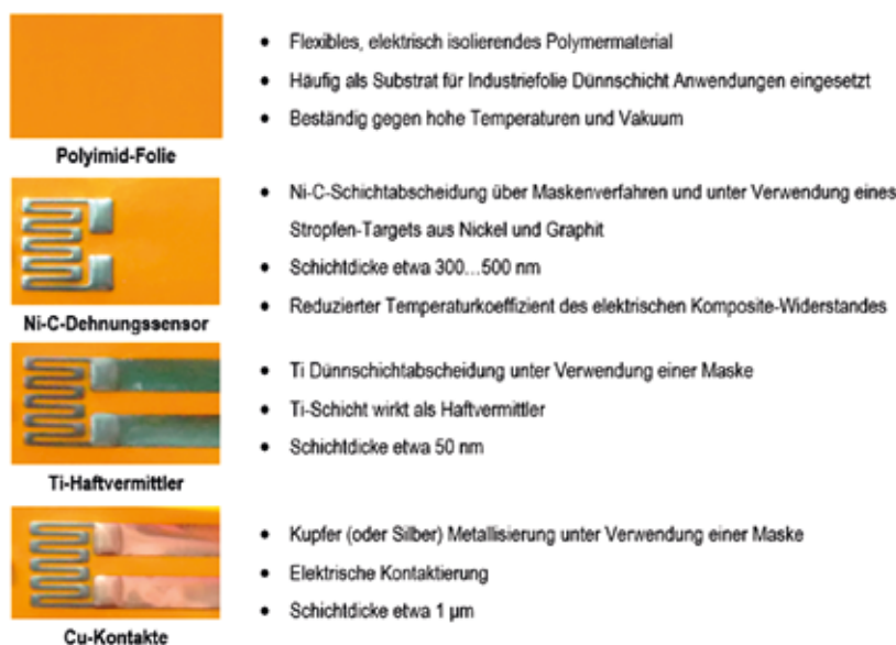
Abb. 1: Herstellungsrouten der Ni-C-Dehnungssensoren mittels DC-Magnetron-Sputterprozess
