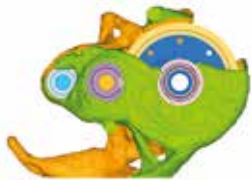
Topologieoptimierung zur Identifizierung der Lastpfade
