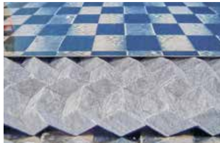
Faltkernstruktur – Kohlenstofffaser-Nassvliese aus einer Mischung von rezyklierten Kohlenstofffasern, PA6-Fasern und PVOH-Bindefasern
