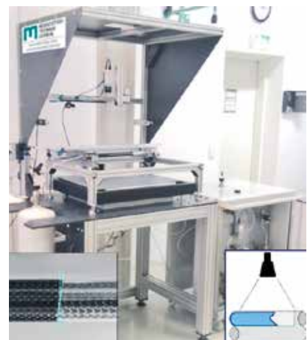
Optische Bestimmung der axialen Permeabilität von Flechtschläuchen.
